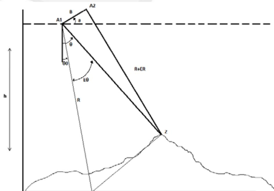
Geometría básica de un par interferométrico derivada entre dos antenas A1 y A2:  $h$ : altura de la antena  $R$ : alcance inclinado (rango),  $ER$ : diferencia de longitud de la trayectoria entre las dos antenas,  $\theta$ : ángulo de vista,  $a$ : ángulo de la línea de base con respecto a su horizontal (cuando el ángulo es formado entre  $R$  y el vector de línea de base corresponde al ángulo de depresión  $B$ ).
